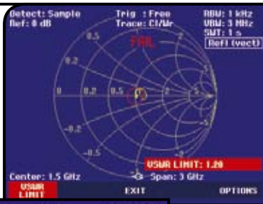
Messung von Betrag und Phase im Smith-Diagramm
