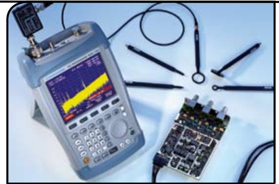
R&S®FSH mit Nahfeldsonden und Messobjekt
